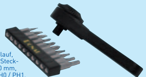
Art. MBS12 - Mini-Bit-Flexi-Dreher Schraubendreher mit flexiblem und festem Schaft und 6 doppelseitigen Mini-Bits, besonders für Arbeiten an unzugänglichen Stellen. Alle Bits im Schaft verstaut: 3 Schlitz 2,0 / 2,5 / 3,0 mm, 3 Kreuzschlitz Typ PH00 / PH0 / PH1, 4 Sechskant 0,9 / 1,5 / 2,0 / 2,5 mm, 2 Torx T5 / T6 Art. MBS12 - mini-bit screwdriver With flexible and fixed shaft to work in narrow areas. With 6 double side bits stored in the shaft. 3 slotted 2.0 / 2.5 / 3.0 mm, 3 cross point type PH00 / PH0 / PH1, 4 hexagon 0.9 / 1.5 / 2.0 / 2.5 mm and 2 Torx T5 / T6
