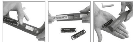
**Mise en place des batteries :** Le stick fonctionne avec deux piles de 1,5 V (R6). Pour les mettre en place faites glisser la case porte-accessoires (4) sur l'extrémité de l'appareil. Placez les deux batteries avec le pôle + vers la pointe de l'appareil. et replacez la case.
