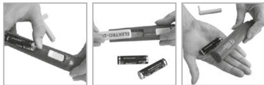
**Inserimento delle batterie:** Lo stick viene alimentato da due batterie da 1,5 V (R6). Per metterle in sede, far scorrere il coperchio porta-accessori (4) oltre l'estremità dell'apparecchio. Inserire le due batterie con il polo positivo + in avanti. Rimettere il coperchio.
